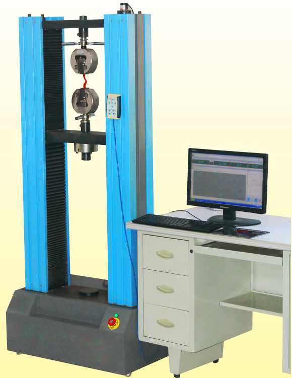
Equipement d'essai à la résistance au déchirement
